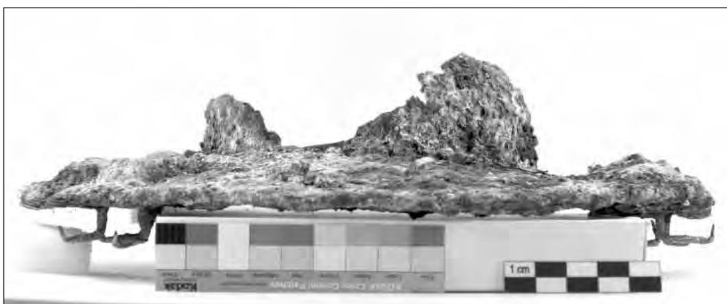
Рис. 4. Фрагмент сильно корродированного железного умбона до реставрации. Фото В.И. Лобанова.
